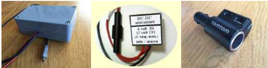
Links het complete "6 to 5 doosje" / Rechts de twee onderdelen die in het doosje zijn samengebracht
