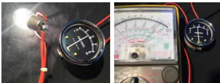
Ampèremeter in serie met lampje / universeelmeter
