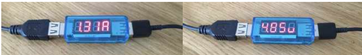
Links: de meter geeft 1,31 A aan / Rechts de meter geeft 4,85 V aan
