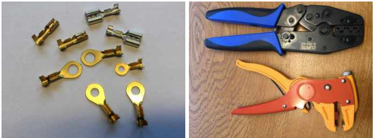
Links een assortiment schuifstekkers en kabeloogjes / Rechts een krimptang voor kabelschoenen van 0,5-6 mm 2 , en een draadstriptang
