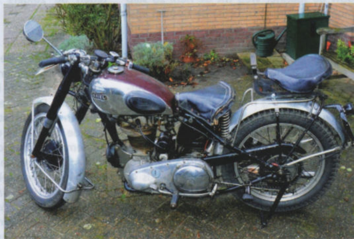
Ariel 500 KH uit 1947 met aluminium cilinderkop. Niet origineel zijn de aluminium spatborden en velgen.
