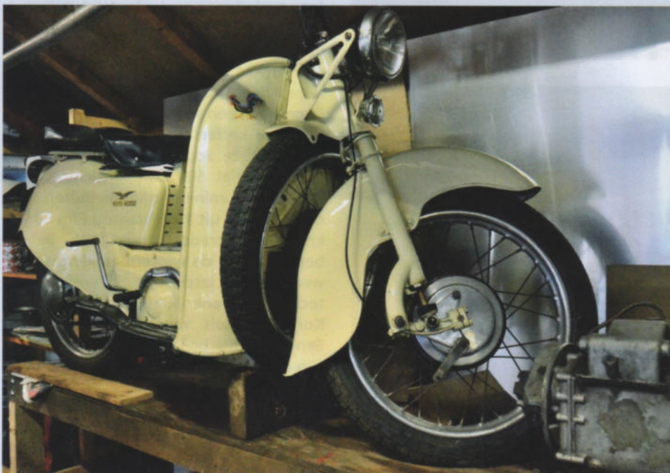
Een lichte 'fiets' van Moto Guzzi, de Cardellino met een simpele, doch doelmatige achtervering.
