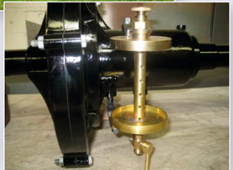
Oliereservoir (zonder glas) bij de achteras van Adrie's Dunlop Ariel tricycle project.
